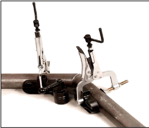
PA-KULMASYSTEEMI KAHDELLA PIHDILLÄ TUOTENRO KUVAAUS PA622 SISÄLTÄÄ SÄÄTÖTUEN 0-180° PXA6 JA KAKSI PG622M PIHTIÄ.
