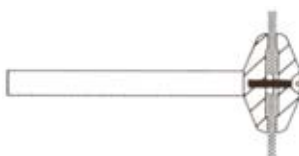
VAIHTOKARALLA 50 X 6,4 mm PAKS. 0,1 - 3,2 mm HALK. 9, 13, 16, 19 mm
