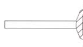
KIINTEÄLLÄ KARALLA 50 X 6,4 mm PAKS. 0,5 - 3,8 mm HALK. 9, 13, 16, 19 mm
